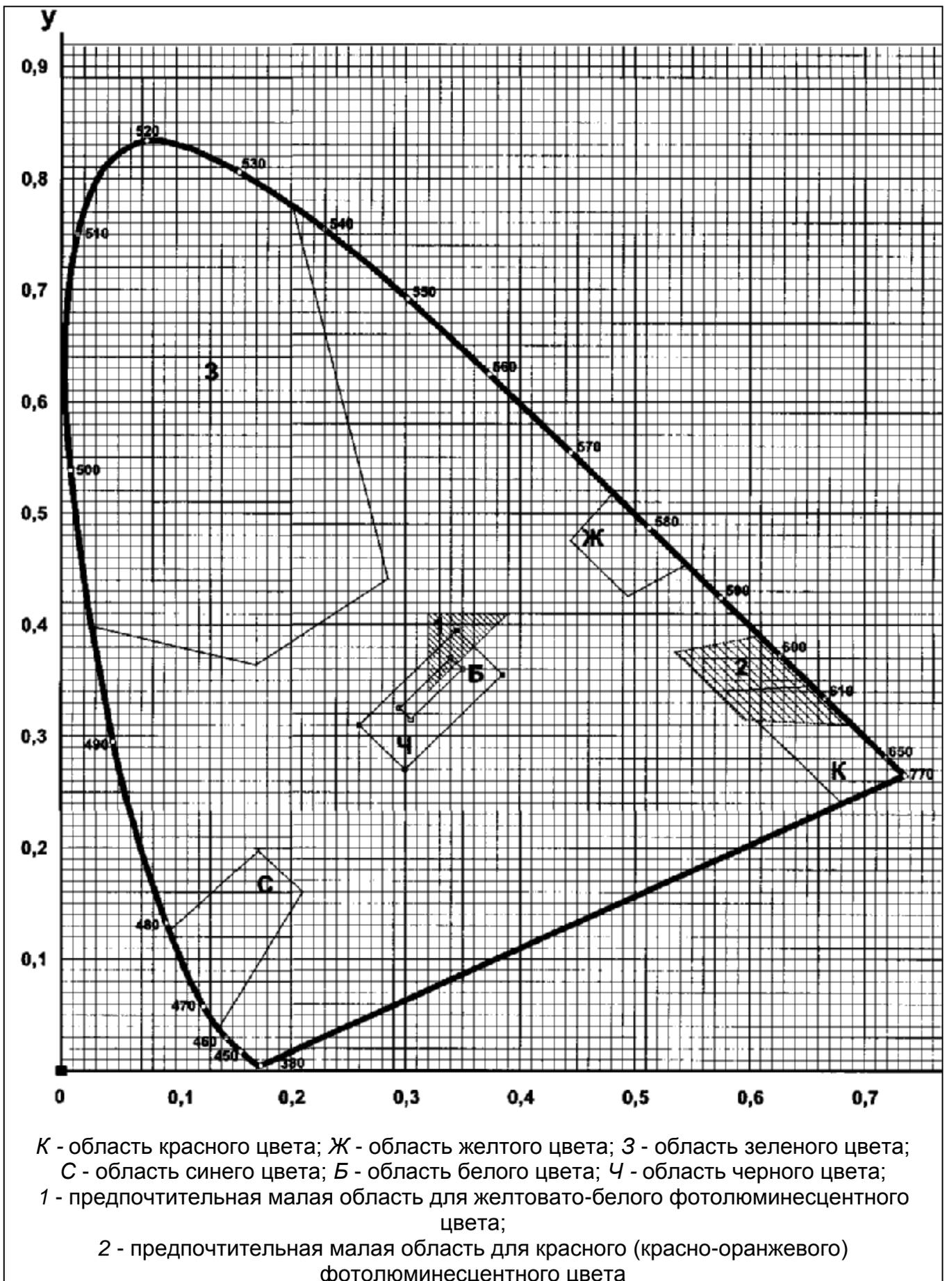
Рисунок Г.1 - Допустимые области цветности сигнальных и контрастных цветов элементов ФЭС, знаков безопасности и сигнальной разметки на стандартном цветовом графике  $x, y$  МКО 1931 г.
